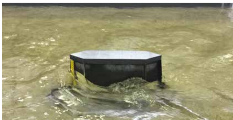
Strömung am Brückenpfeiler bei Hochwasser im Modell 1:30 (Foto: IRR).
